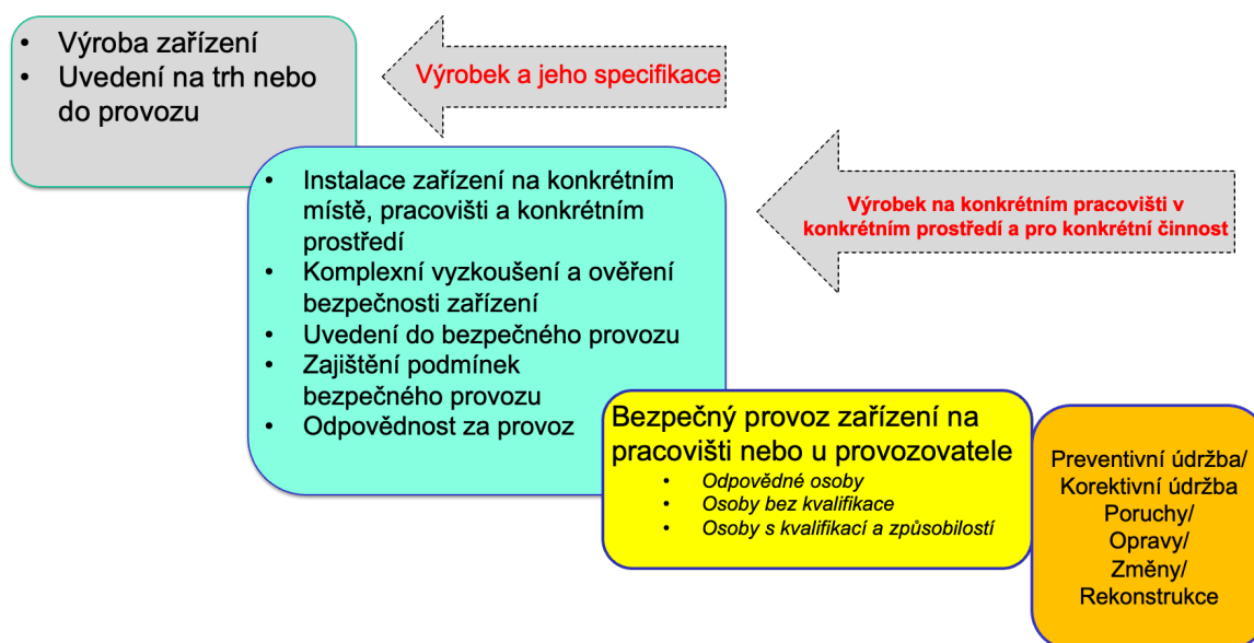
Obrázek: Příklad jednotlivých kroků procesu „péče o technickou a provozní bezpečnost VTZ
